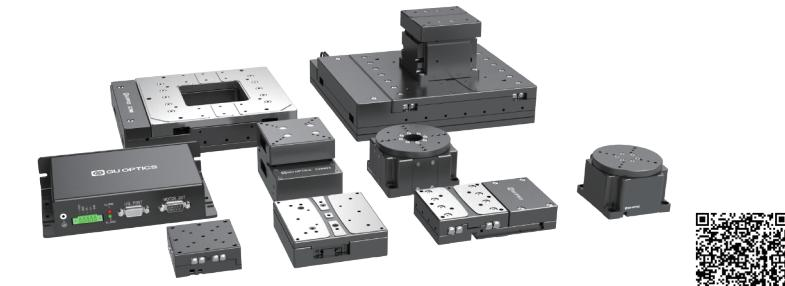
压电马达驱动的位移台没有传统电磁马达(伺服或步进电机)驱动的位移台所需的丝杆或蜗轮蜗杆组等传动部件，是一种直接耦合驱动没有回程间隙的驱动方式，断电可耦合自锁。
