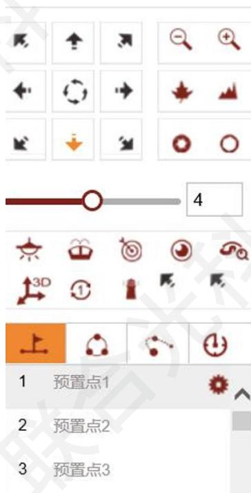
运动控制：长按方向控制键可控制云台按水平，垂直等方向转动；点击
