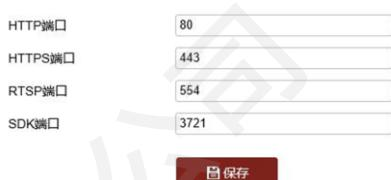
端口配置参数可以设置“HTTP 端口（默认 80）”、“HTTPS 端口（默认 443）”、“RTSP 端口（默认 554）”和“SDK 端口（默认 3721）”通过网络访问设备时可根据需要设置相应的端口。
