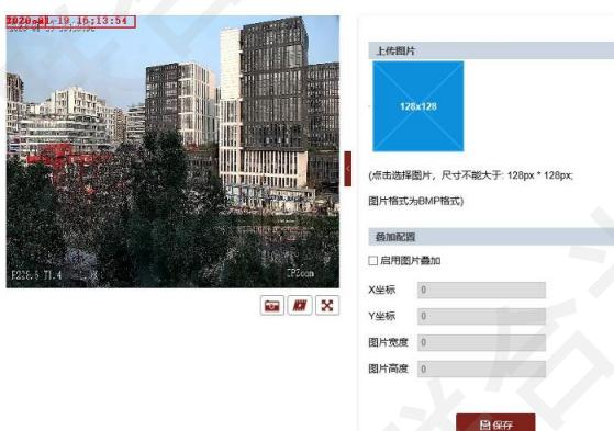
图片叠加功能需要用户先准备需要叠加在视频上的图片，图片格式须为 BMP 位图，尺寸不能大于 128\*128 像素。
