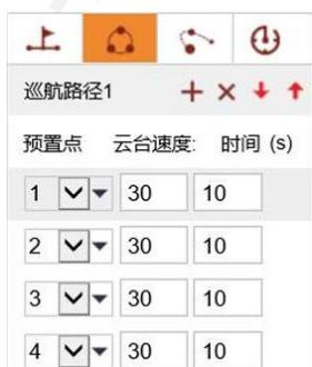
步骤4 巡航点设置完成后，点击确认，完成巡航路径设置。对已设置的巡航路径可进行调用、暂停、修改和删除操作：
