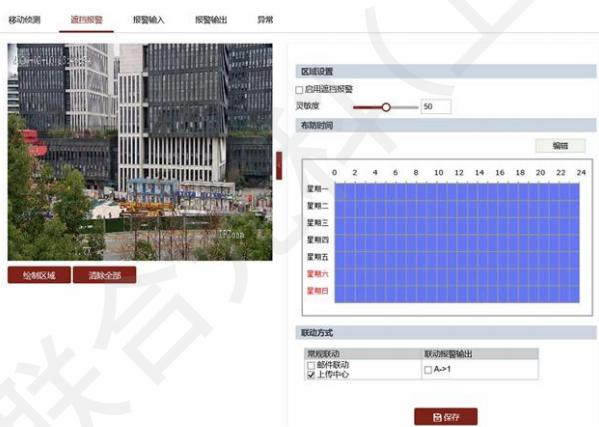
步骤 1 勾选“启用遮挡报警”可开启设备遮挡报警功能。
