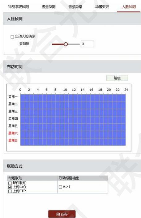
步骤 1 勾选“启用人脸侦测”可开启设备人脸侦测功能。灵敏度越高，越容易侦测到人脸。
