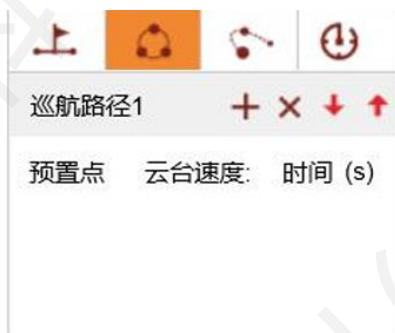
步骤3 点击 $+$ 按键，添加巡航点，设置对应的前置点、巡航速度和停留时间。每条巡航路径可以设置32个巡航点。如图2.12所示。
