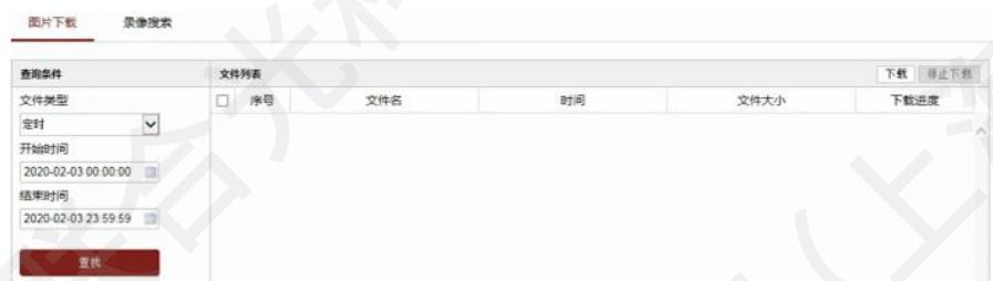
步骤 1 选择图片文件类型和图片存储开始/结束时间段，点击“查找”，将符合条件的图片文件显示在右侧列表中。
